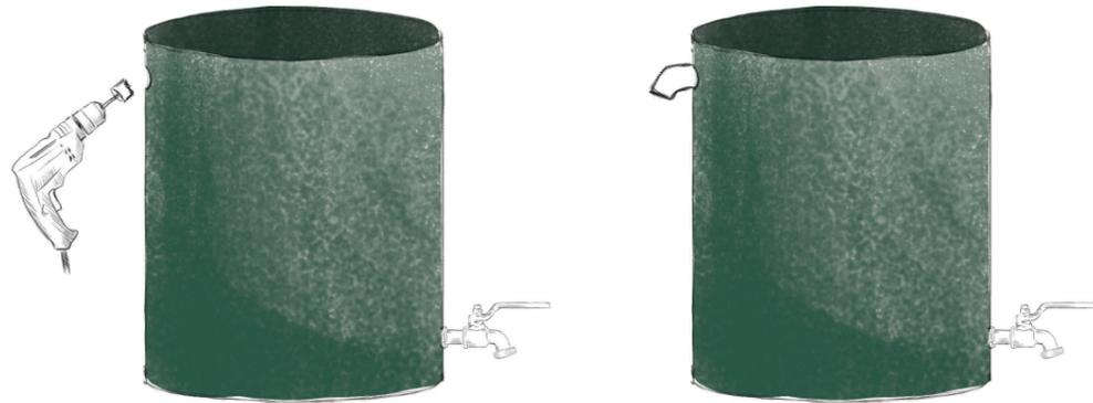
À présent, il faut trouver l'emplacement adéquat pour placer le récupérateur d'eau de pluie. Idéalement, il est placé sous une descente de gouttière et près d'une grille d'évacuation d'eau de pluie. La gouttière rejette l'eau dans le bidon et le « trop-plein » rejette l'eau dans la grille d'évacuation lorsque le bidon est plein. Et pour que tu puisses remplir un arrosoir avec le robinet, il faudra surélever le bidon en le plaçant sur deux moellons ou deux palettes en bois par exemple.
